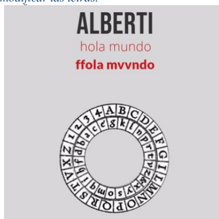
Fig. 117 Cifrado Alberti, donde con ayuda de dos círculos con letras es posible cifrar un mensaje utilizando un cifrado de tipo sustitución.
