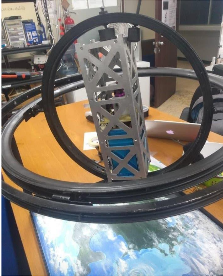
Figura 41. Ensamble de la estructura mecánica
