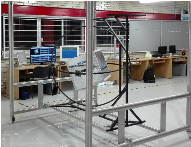
Figura 14. Banco de pruebas de un sistema de control de orientación para satélites.
