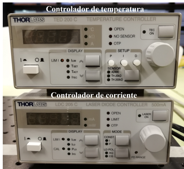
Fig. 13. Controladores de corriente y temperatura.
