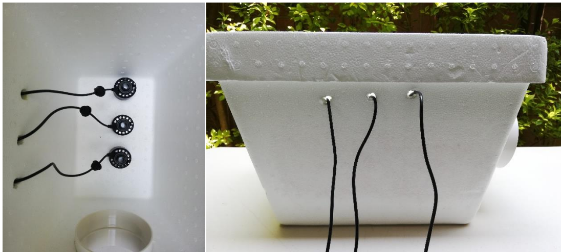
Figura 73. En la imagen del lado izquierdo se observa el interior de la hielera con los 3 generadores de neblina. En la imagen del lado derecho una toma de costado de la hielera.
