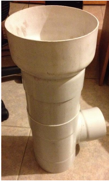
Figura 64. Acoplamiento de sistema de tubería para prototipo de generación de agua del aire
