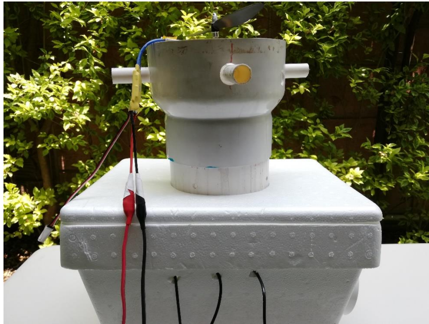
Figura 74. Acoplamiento de la tapa de la hielera con tubería de PVC y reducción de 8 in a 6 in
