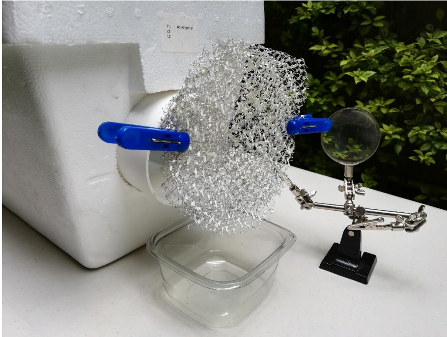
Figura 76. Armado completo con las mallas para iniciar las pruebas de recolección
