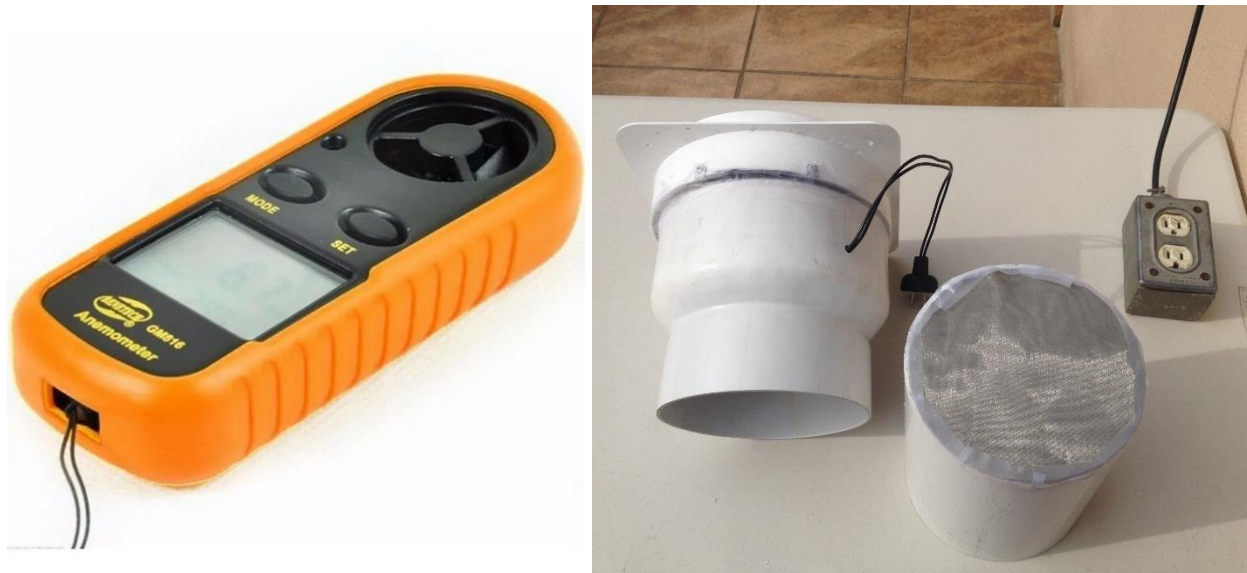
Figura 61. Anemómetro digital Gm816. Acoplamiento de ventilador, reducción de 8" a 6" y malla de acero inoxidable tipo tamiz
