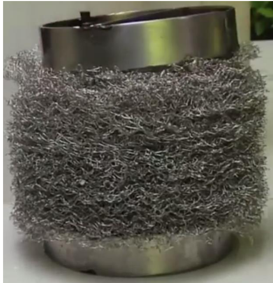
Figura 63. Fotografía de eliminador de niebla de 6[in]
