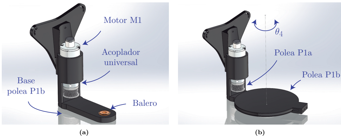
Figura 3.11: 4to GDL y sus elementos. (a) Se omite la polea 1b para visualizar mejor los elementos ubicados por debajo. (b) Se muestran ambas poleas y el eje de revolución \theta_4 .
