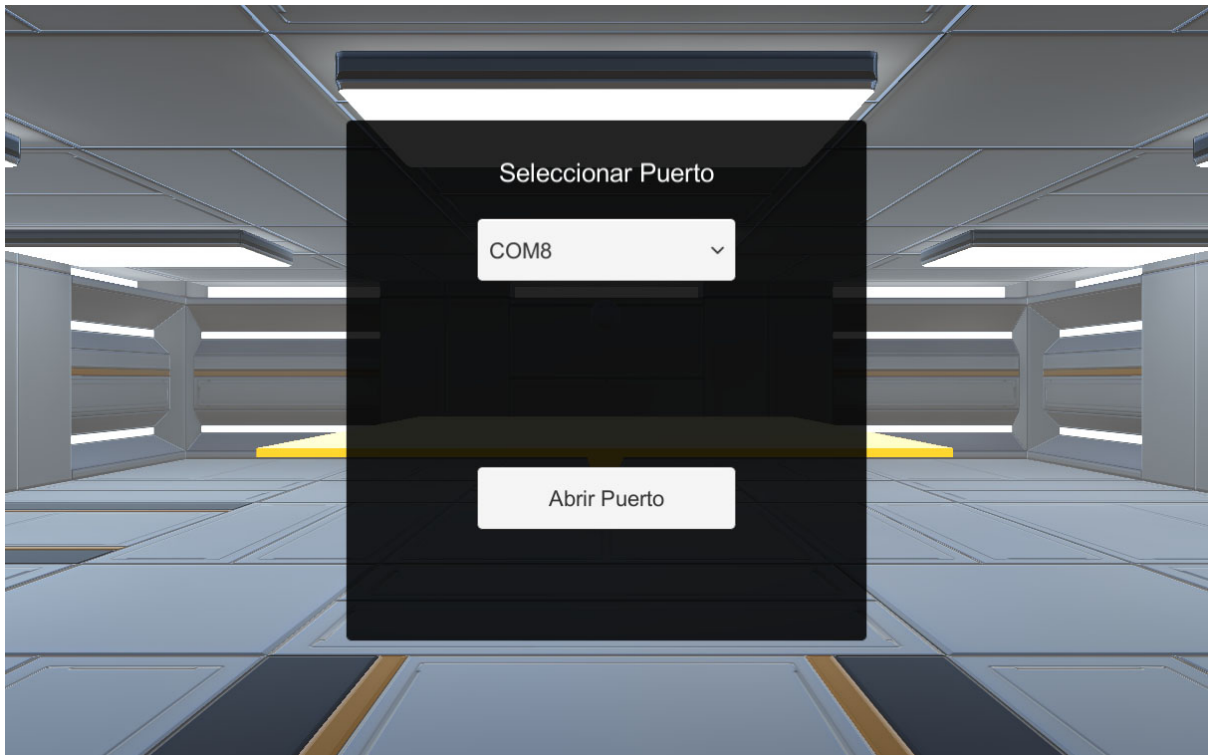
Figura 4.3: Configuración del puerto serial en Unity .
