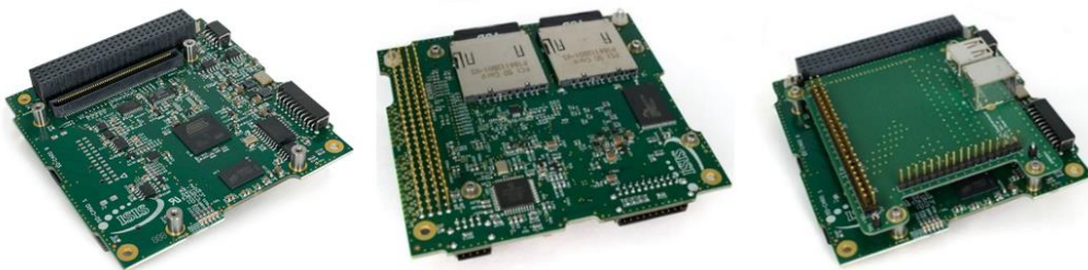
Figura 10. IOBC, vistas superior, inferior e integrada a una daughterboard [4]
