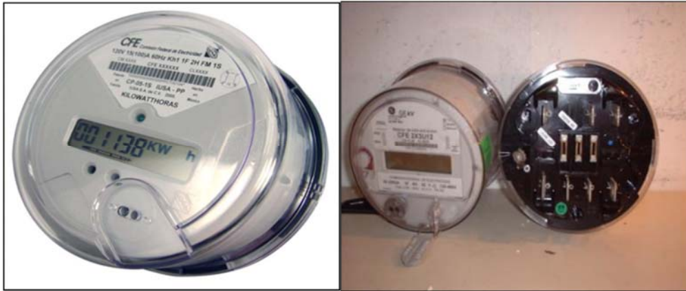
Ilustración 33medidor de estado sólido (usan circuitos integrados)
