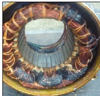
Figura 4.20 Sobrecalentamiento en devanados.
