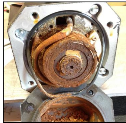
Figura 4.18 Resolver dañado por afectaciones en el interior del servomotor.
