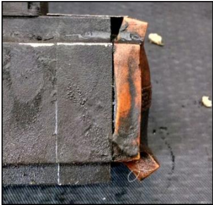
Figura 4.8 Daño en tapa trasera de un servomotor por altas temperaturas.
