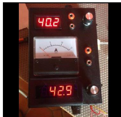
Figura 4.35 Proyecto de fuente de voltaje de CD finalizado.
