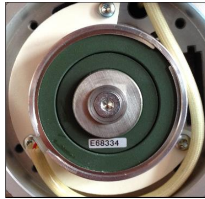
Figura 4.24 Resolver de ensamble por presión Figura 4.25 Resolver de ensamble por sujeción
