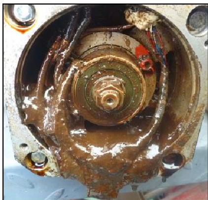
Figura 4.19 Motor con suciedad interna.
