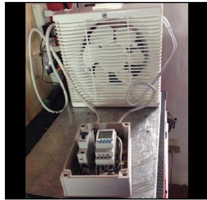
Figura 4.41 Extractor de aire con temporizador.
