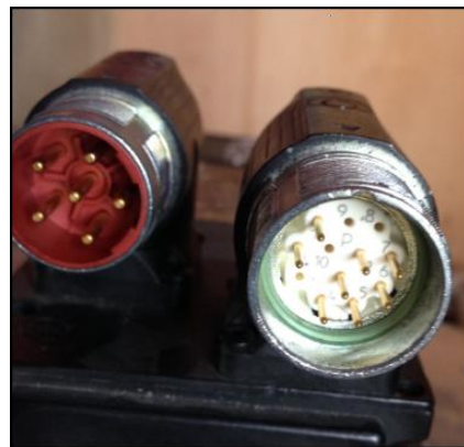
Figura 4.11 Información en conector sobre la identificación de pines.
