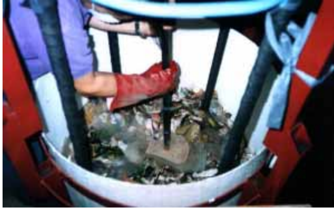
Fotografía III.3. Compactación de los residuos sólidos en lisímetros
