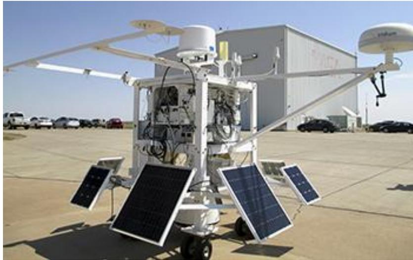
Figura 1: Góndola de la NASA en la que viajó el PIXQUI I [1].
