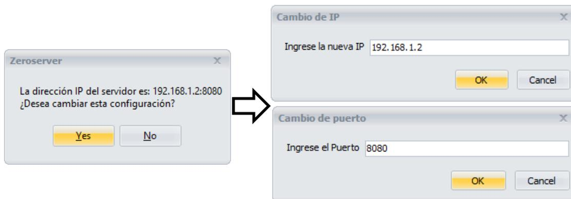
Figura 2.7 Cambio de la dirección IP y puerto del servidor Zero
