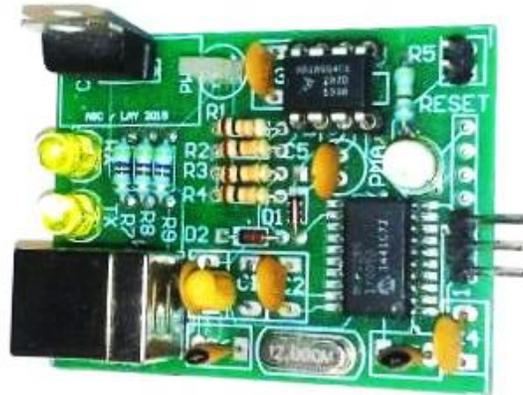
Figura 0.6 Fotografía del convertidor USB-SERIE III con llave para MINIBAS8A
