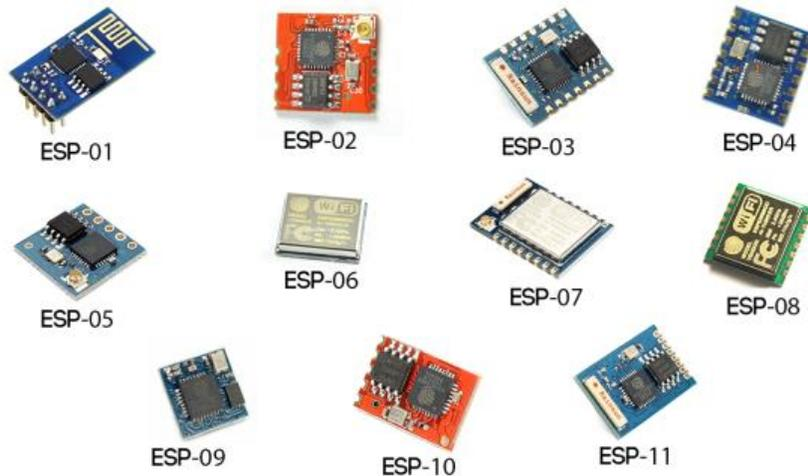
Figura 3.1 Diferentes versiones del Módulo ESP8266 Wifi (fuente [12])
