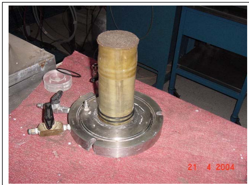
Fig. 4.4 Probeta de suelo impregnada con sílice coloidal
