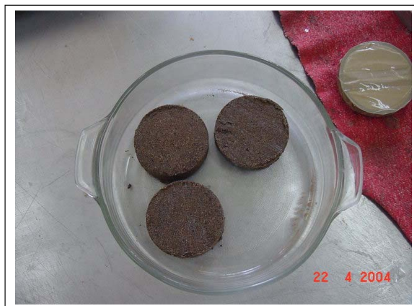
Fig.4.5 Especímenes de ensaye (muestra de suelo impregnada)
