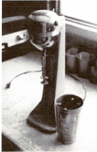
FIGURA 4.- Balidora para la preparación de la muestra de suelos arcillosos o cohesivos
