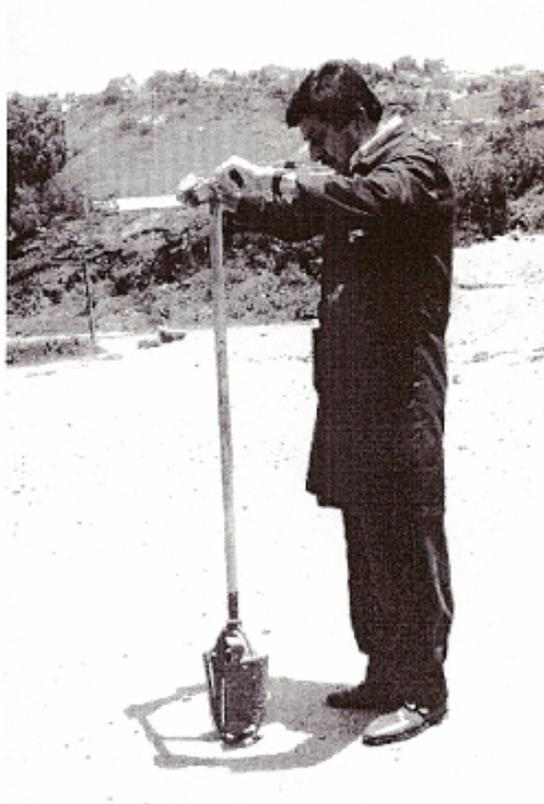
FIGURA 6.- Inicio de un muestreo utilizando posteadora
