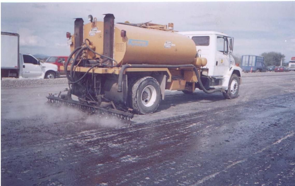
LAS PETROLIZADORAS ERÁN CAPACES DE ESTABLECER A TEMPERATURA CONSTANTE, UN FLUJO UNIFORME DEL MATERIAL ASFÁLTICO SOBRE LA SUPERFICIE POR CUBRIR, EN ANCHOS VARIABLES Y EN DOSIFICACIONES CONTROLADAS; ESTABAN EQUIPADAS CON ODÓMETRO, MEDIDORES DE PRESIÓN, DISPOSITIVOS ADECUADOS PARA LA MEDICIÓN DEL VOLUMEN APLICADO Y TERMÓMETRO PARA MEDIR LA TEMPERATURA DEL MATERIAL ASFÁLTICO DENTRO DEL TANQUE; Y CONTABAN CON UNA BOMBA Y BARRAS DE CIRCULACIÓN COMPLETAS, QUE PODIAN AJUSTARSE VERTICAL Y LATERALMENTE.
