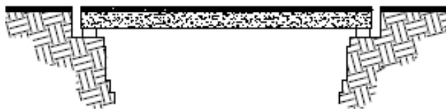
Viga simplemente apoyada
