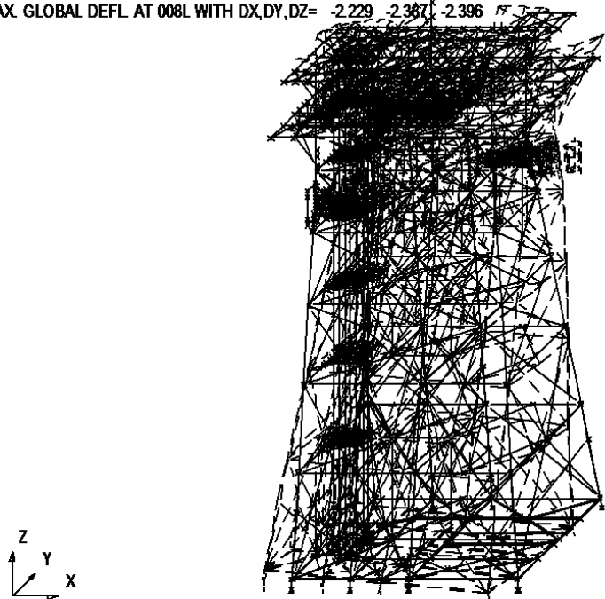
Figura 70 Configuración deformada del modo de vibrar 8 (Y)
