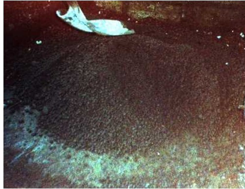
Figura 8. Elaboración de mezcla para fabricación de tabicones: a) incorporación del residuo con arsénico sustituyendo al agua; b) mezcla y homogeneización de los componentes para la fabricación de tabicones.
