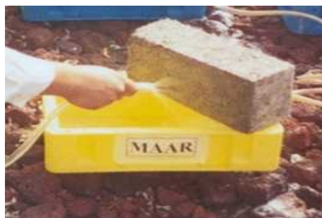
Figura 13. Aplicación de lluvia sobre los tabicones.
