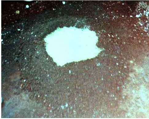
Figura 8. Elaboración de mezcla para fabricación de tabicones: a) incorporación del residuo con arsénico sustituyendo al agua; b) mezcla y homogeneización de los componentes para la fabricación de tabicones.
