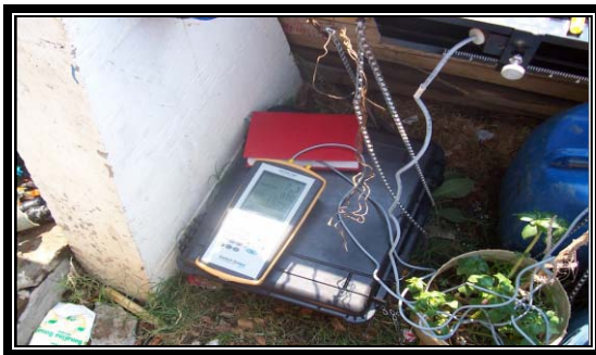
Foto 15, 16, 17 y 18 - Instalación del medidor a la salida del equipo de bombeo.
