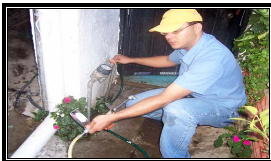
Foto 35, 36, 37, 38, 39,40, 41, 42, 43, 44, 45, y 46.- Medición de presiones en la zona de estudio.
