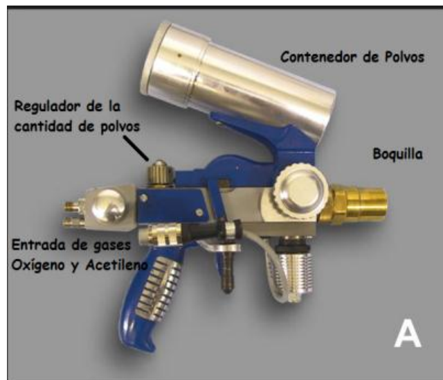
Fig. 2.4 Pistola de proyección térmica de polvos. [16]
