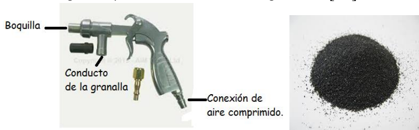
Fig. 2.1 Representación del sistema de granallado[13].
