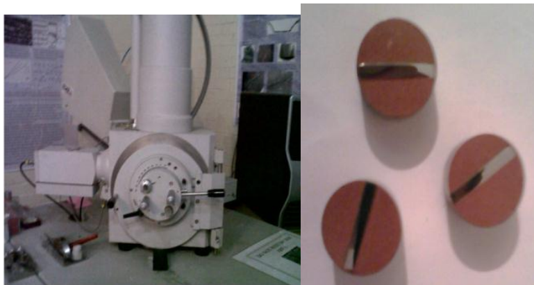
Fig. 2.17. Microscopio electrónico Philips XL20 y probetas empastilladas en resina de cobre.
