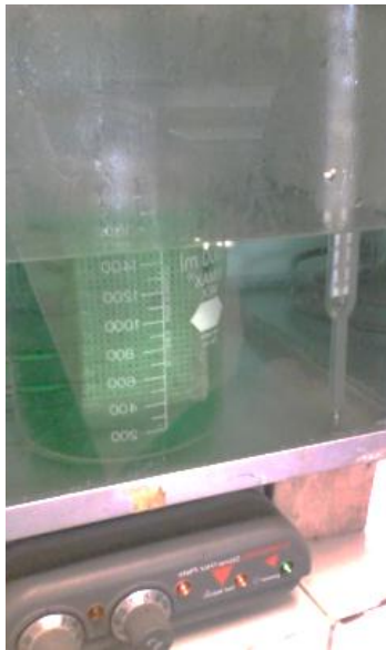
Fig. 2.13 Baño químico sumergido en el baño termostático durante la deposición del níquel.
