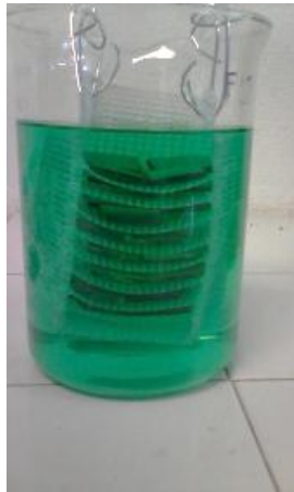
Fig. 2.11 Imagen del baño químico con las probetas sumergidas.
