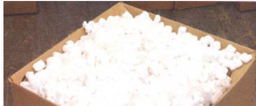
Figura 4-6 Material de acolchonamiento Fuente: OPESA (2009)
