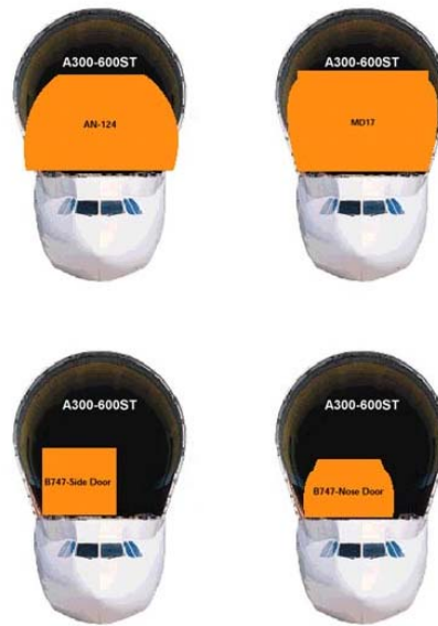
Figura 7-44 Corte transversal y comparativa del Airbus Beluga Fuente : Airbus
