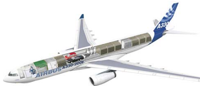
Figura 7-39 Esquema general de carga del A330-200F Fuente: Airbus
