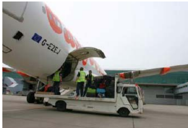
Figura 7-10 Camión Flat-Bed Fuente: Airbus
