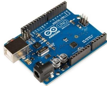
Figura 35. Microcontrolador Arduino Uno.
