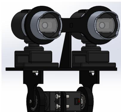
*Figura 28. Sujeción de las cámaras*
