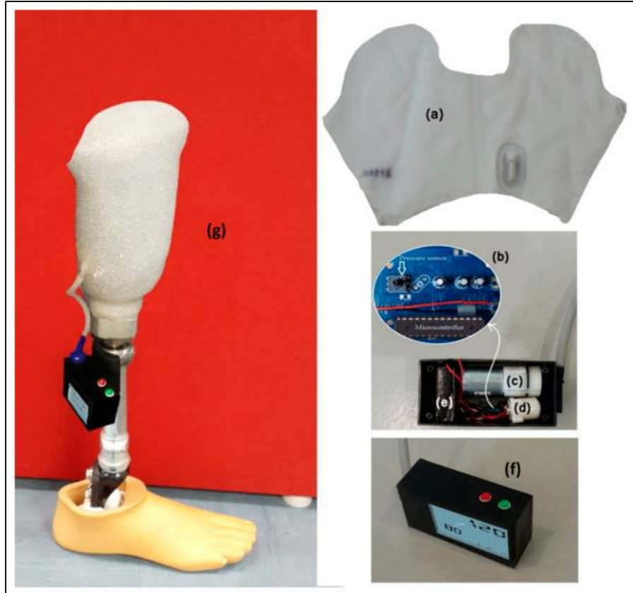
Figura 1.8. Prótesis con sistema neumático APSS. a) cámara de aire, b) tarjeta de circuito de control, c) bomba, d) válvula, e) batería, f) sistema de operación, g) prótesis transtibial ensamblada [38].
