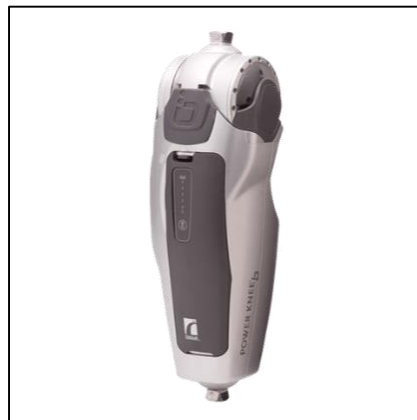
Figura 1.17. Prótesis de rodilla Power Knee® - Össur®.
