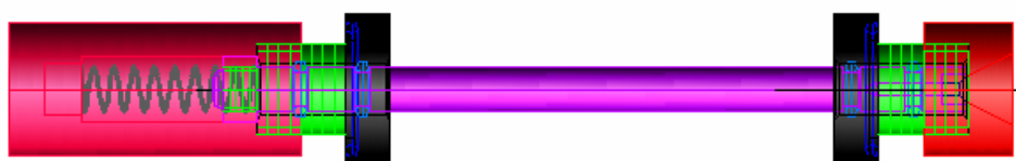
Figura 6.7. Válvula de activación normalmente cerrada
