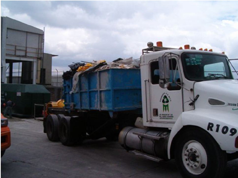
Foto 24. La forma más conveniente para acopiar y retirar los materiales de desecho, producto de las tareas de Mantenimiento, es con el uso de contenedores
