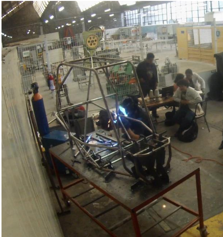
Figura 3.22 Finalización del proceso de soldadura del chasis
