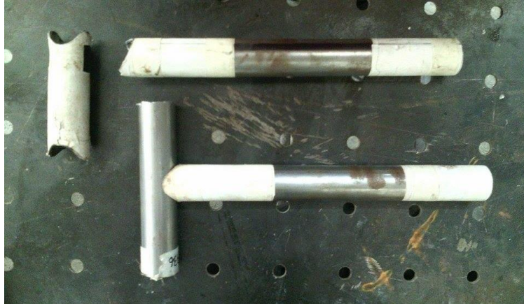
Figura 3.16 Implementación física de plantillas en la manufactura del chasis del prototipo 2015
