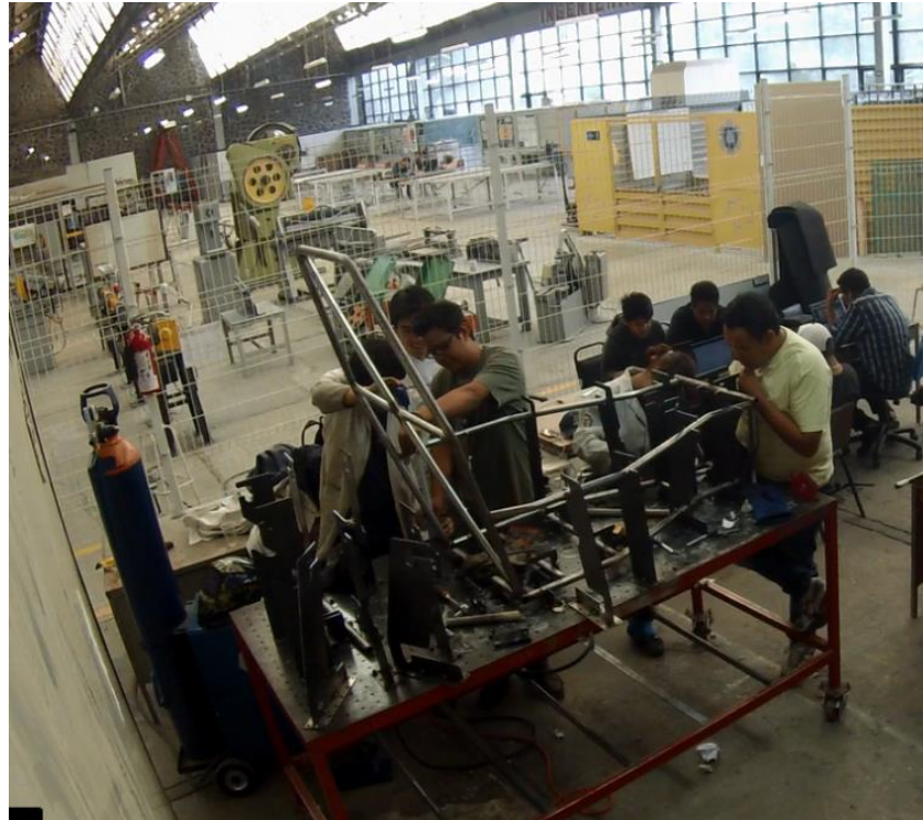
Figura 3.20 Montaje de los SIM de la estructura sobre los escantillones
