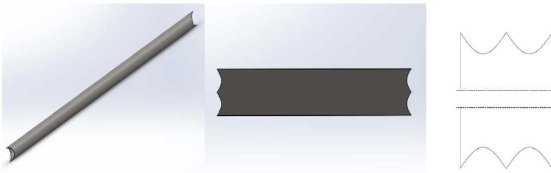
Figura 3.15 Proceso de obtención de las plantillas de los abocardados de los tubos del chasis
