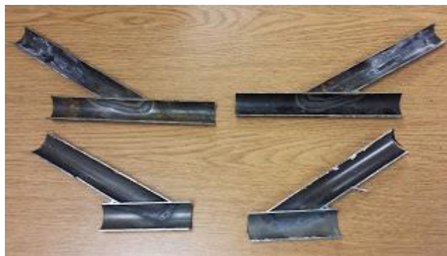
Figura 4.2 Prueba de inspección destructiva
