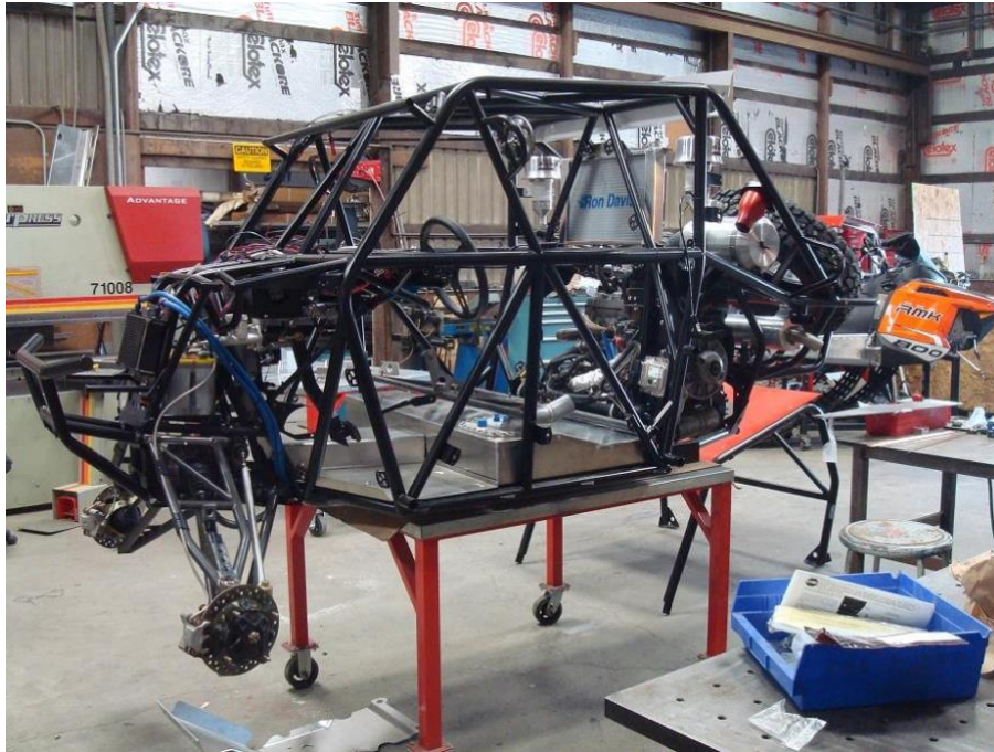
Figura 1.8 Chasis de estructura espacial [18]
