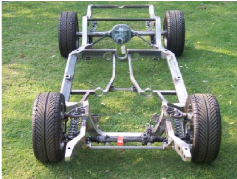
Figura 1.6 Chasis tipo escalera [16]
