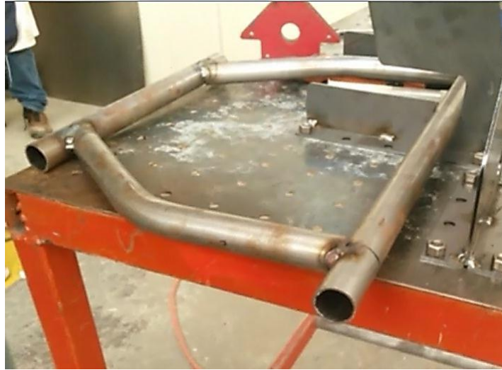
Figura 3.13 Dobleces implementados en miembros estructurales del chasis
