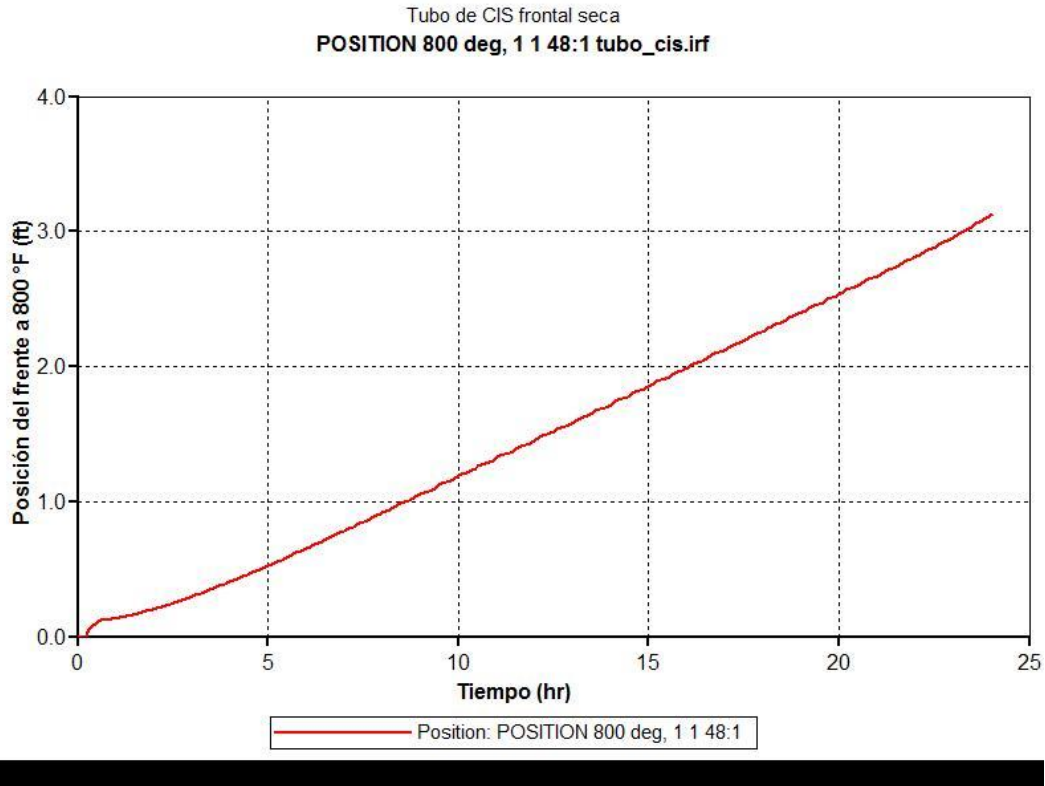
Figura 5.14 Posición del frente de combustión a una temperatura de 800 °F.
