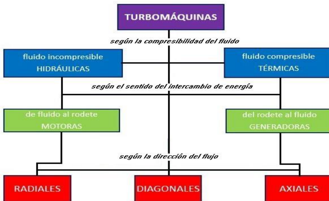
Figura 2. 1 Clasificación de las turbomáquinas (Mataix, 1973).
