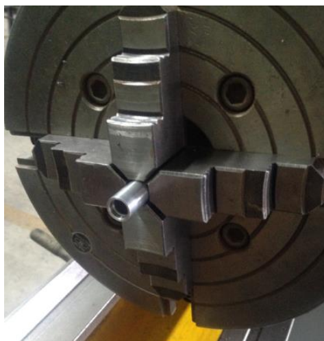
Figura 3. 21 Maquinado del conducto de entrada de vapor.
