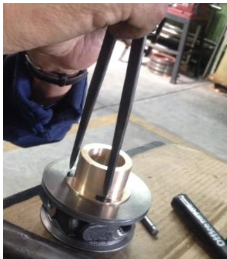
Figura 3. 19 Trazado del círculo de barrenos.
