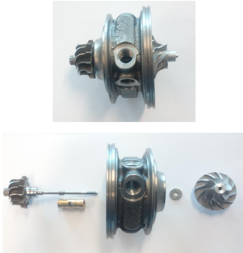
Figura 3. 2 Turbocompresor de automoción para vehículo SMART.
