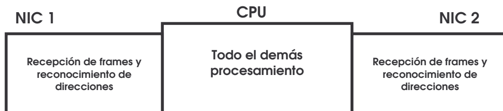
Figura 2.2 Arquitectura de hardware usada en sistemas de red basadas en software. La CPU maneja casi todas las tareas para el procesamiento de protocolos.
