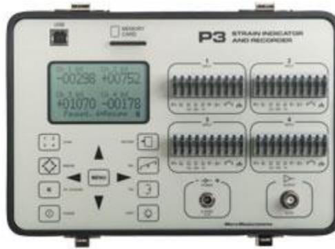
Figura 1-8. Indicador de deformaciones portátil [14].
