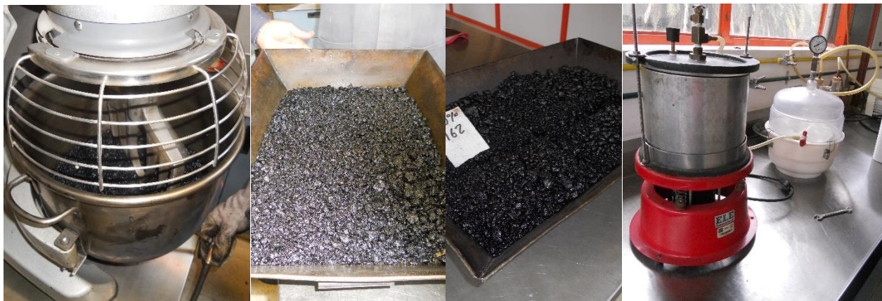
Figura 36. Determinación de la gravedad específica máxima teórica "Densidad RICE", a las mezclas realizadas para esta investigación
