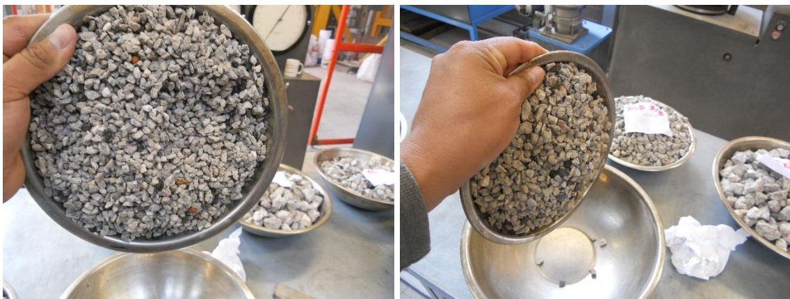
Figura 21. En la proporción 6:1 del rango de tamiz No.8 (2.36mm) al No. 16 (1.18mm) se unen considerablemente entre sí
