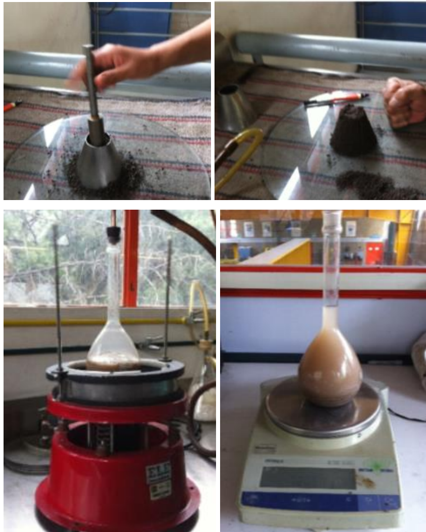
Figura 28. Ensayo a la Gravedad específica y absorción para la arena
