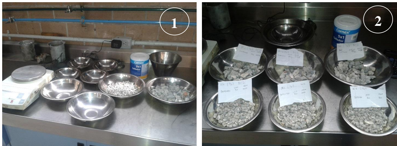
Figura 19. En esta investigación se definieron las proporciones 4:1, 5:1, 6:1, 7:1, se realizan pruebas de inspección para garantizar cual es la idónea para el agregado reciclado, primeramente se dosifica el material
