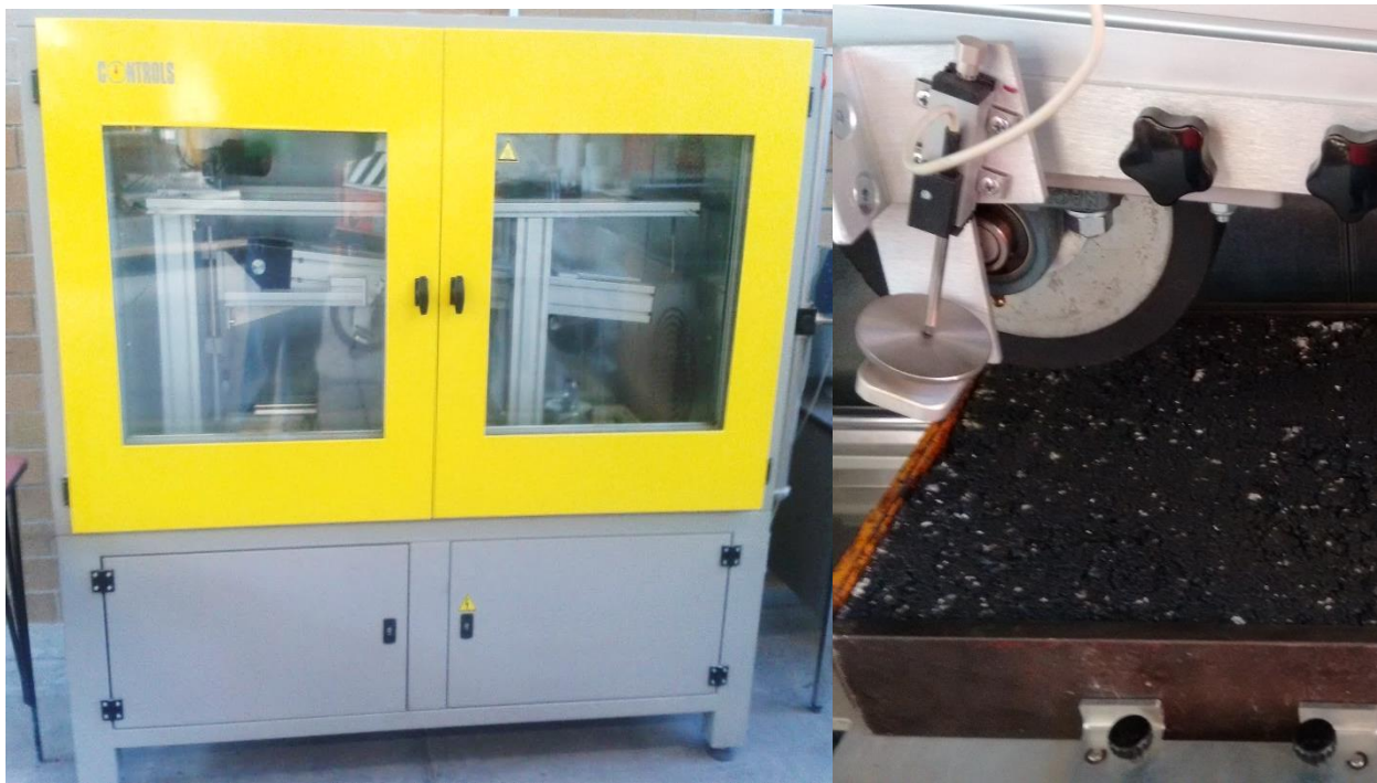
Figura 42. Equipo para ensayo de rueda de pista en laboratorio, dispositivo pequeño: Esta integrado con un termostato de temperatura (temperatura de ensayo de 60°C), con una duración de 10,000 ciclos, se puede aplicar una carga de 700±10 N a una frecuencia de 26.5±1.0, internamente tiene un neumático de goma y el dispositivo de medición de la deformación de la rodera en la probeta, este va registrando sobre un eje longitudinal de la probeta (230mm) la deformación en milímetros por cada ciclo durante los 10 000 ciclos
