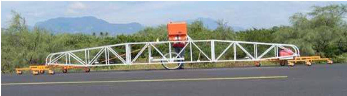
Ilustración 10 Perfilógrafo Longitudinal de California
