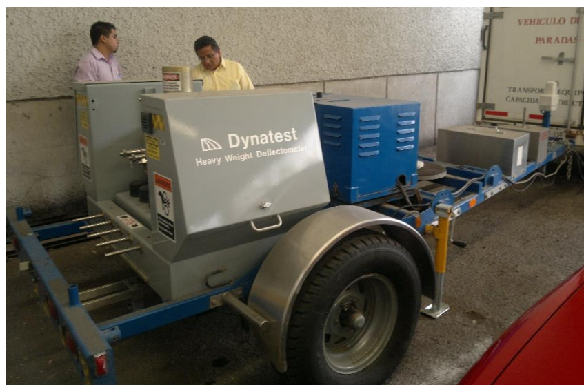
Ilustración 14 Deflectómetro de impacto HWD
