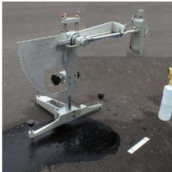
Ilustración 13 Péndulo de fricción británico
