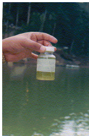
Figura 22.-Obtención de la muestra, los volúmenes de muestra variaron, para la concentración y purificación de la toxina fueron de 20 litros.
