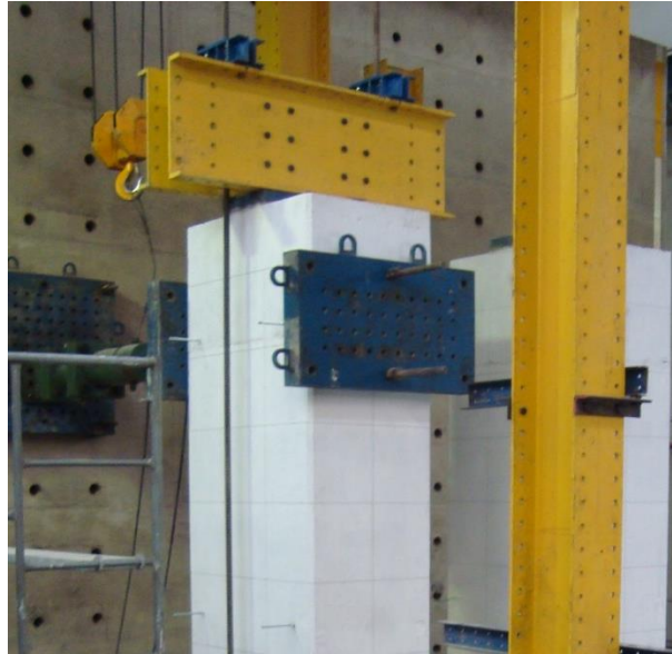
Figura 1.10 Placas Metálicas en el cabezal
