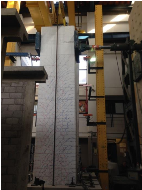
a) Zonas de formación de grietas por tensión diagonal
