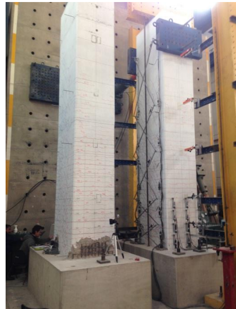
b) Zona de grietas debido a la flexión
