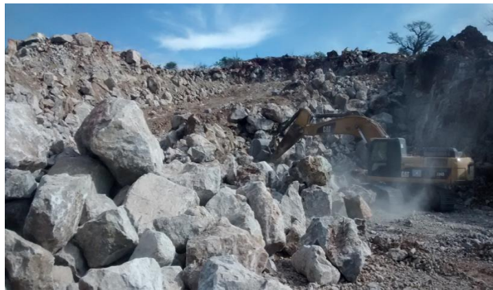
Figura 4.3.1.2 Selección de roca producto de la voladura.
