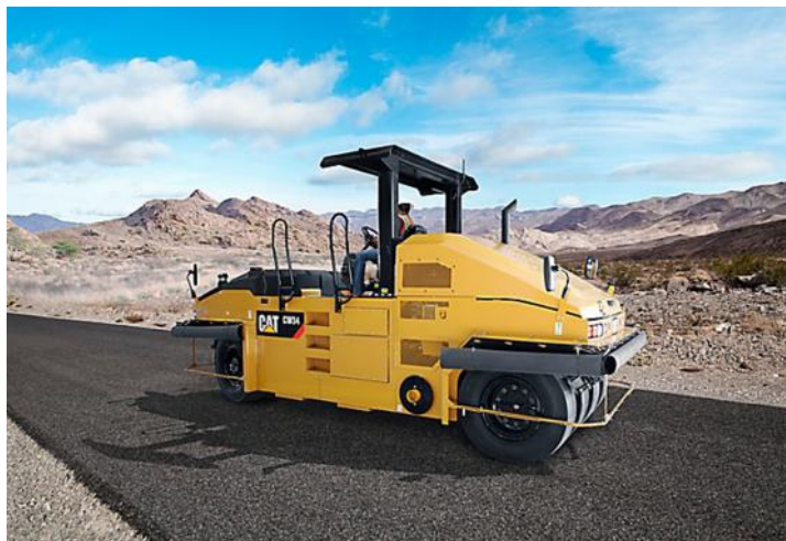
Figura 4.3.4.5 Compactación de sello con compactador neumático.
