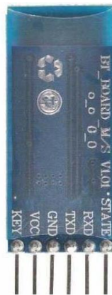
Figura 3.3. Módulo Bluetooth HC05.
