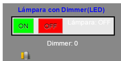
Figura 6.3. Control dimmer para lámpara LED de 12 V.
