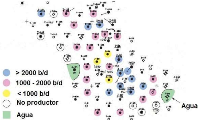
Figura 6.32 Avance del contacto agua – aceite del Campo Carbonatos, 1989. Se presenta el segundo frente de invasión en el campo, además el primer frente freno su avance <sup>(76)</sup>.
