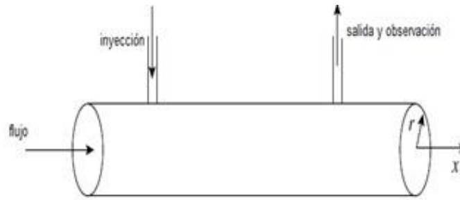
Fig. 3 2 Modelo ideal de inyección en un capilar del medio poroso.
