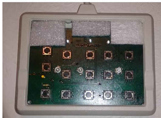
Figura 39, Control de camilla con máscara antisoldante
