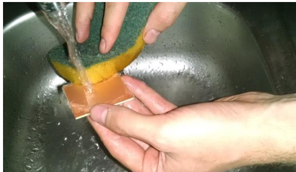
Figura 27, Limpieza de la placa
