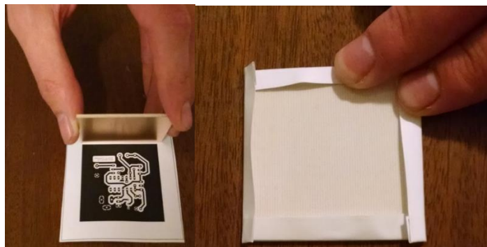
Figura 28, Colocación del papel sobre la placa
