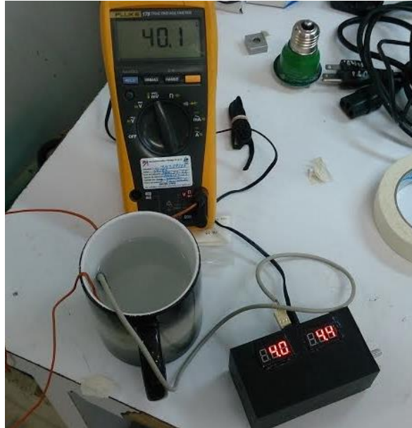
Figura 53, Sensor de temperatura y Multímetro Calibrado
