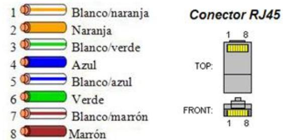
**Figura No. 3. Configuración del cableado T568-B**
