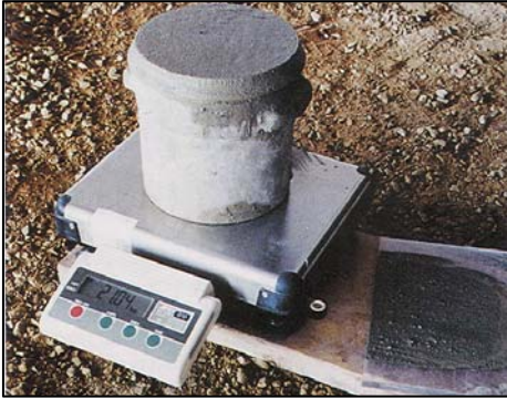
Fig. 3.10 Se pesa el concreto fresco en un recipiente de volumen conocido para la determinación de la masa volumétrica.
