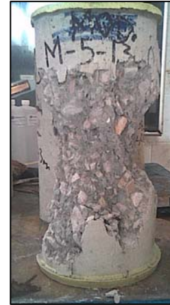
Fig. 3.12 Falla de cilindro ensayado a compresión simple.
