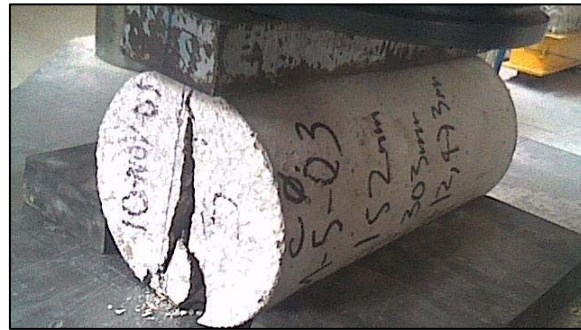
Fig. 3.17 Falla de cilindro ensayada a tensión indirecta.
