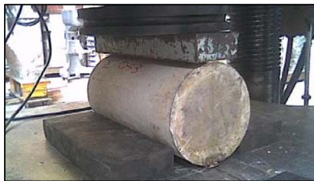
Fig. 1.19 Ensaye a Tensión por compresión diametral
