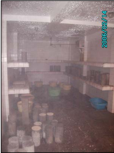
Fig. 2.3 Cámara Húmeda. H. R. de 100%
