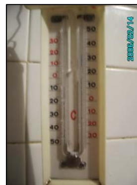
Fig. 2.2 Termómetro en cámara húmeda. Temperatura prom. 23 °C.
