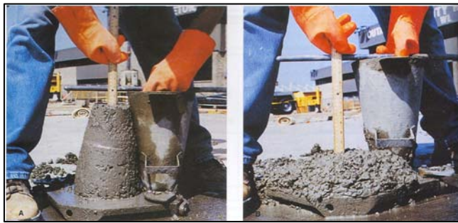
Fig. 1.14 Prueba de Revenimiento
