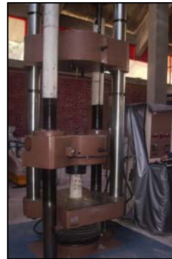
Fig. 3.13 Máquina universal de capacidad de 250 ton. (Izquierda)
