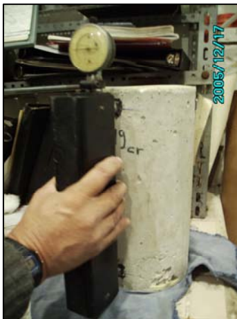
Fig. 3.26 Mediciones empleando deformímetro (equipo whitmore)
