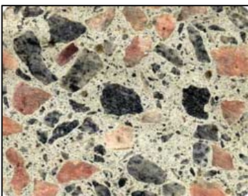
Fig. 1.7 Distribución del agregado en el concreto
