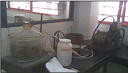
Fig. 3.30 De izquierda a derecha: desecador al vacío, agua destilada, vacuómetro, recipiente con agua destilada y bomba de vacío.
