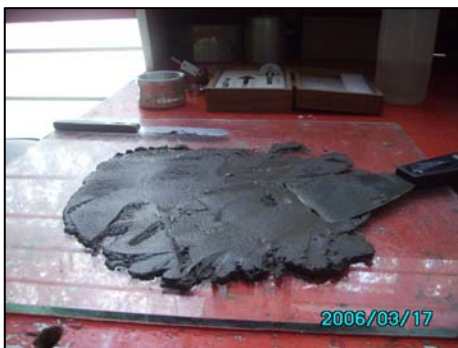
Fig. A6.4 Arena preparada para colocar en molde.
