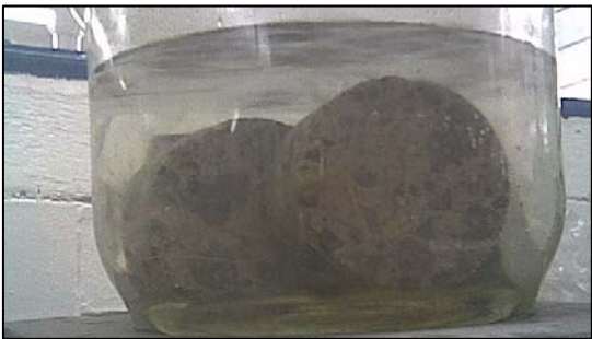
Fig. 3.32 Desecador de Vacío.
