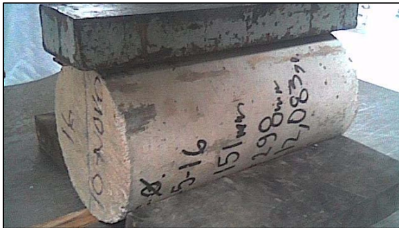
Fig. 3.16 Ensayo a tensión indirecta de cilindro de concreto en laboratorio.
