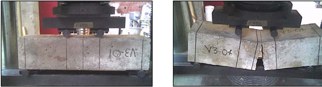
Fig. 1.20 Ensayo a Tensión por Flexión (Módulo de Ruptura)
