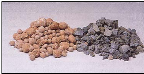
Fig. 1.8 Agregado ligero. Arcilla expandida y esquisto expandido
