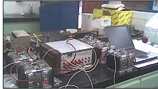
Fig. 3.31 De izquierda a derecha: celdas medidoras con empaques, unidad microprocesador de fuente de energía y PC.
