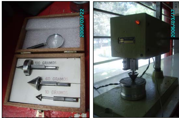
Fig. A6.3 Penetrómetro o cono sueco (Izquierda), lupa y plomadas de 30, 60 y 100 g. (Derecha).
