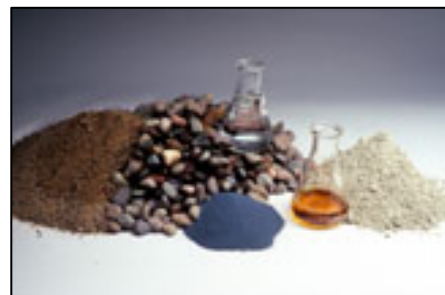
Fig. 3.2 Componentes del concreto de baja resistencia.
