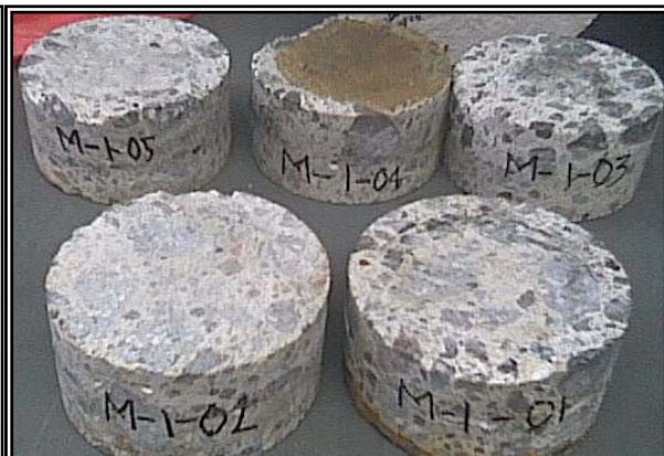
Fig. 3.35 Espécimen de concreto de 100 mm de diámetro y 50 mm de espesor.
