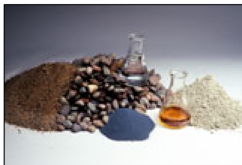
Fig. 1.3 Materiales para concreto
