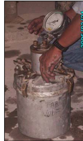
Fig. 3.11 Medidor del tipo de presión para determinar el contenido de aire.
