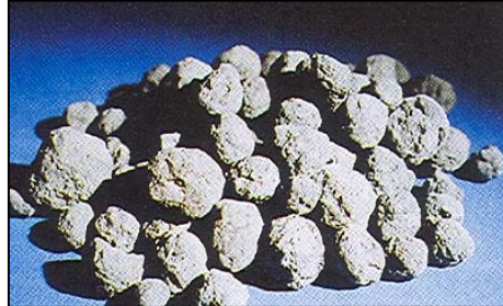
Fig. 1.5 Clinker de cemento pórtland
