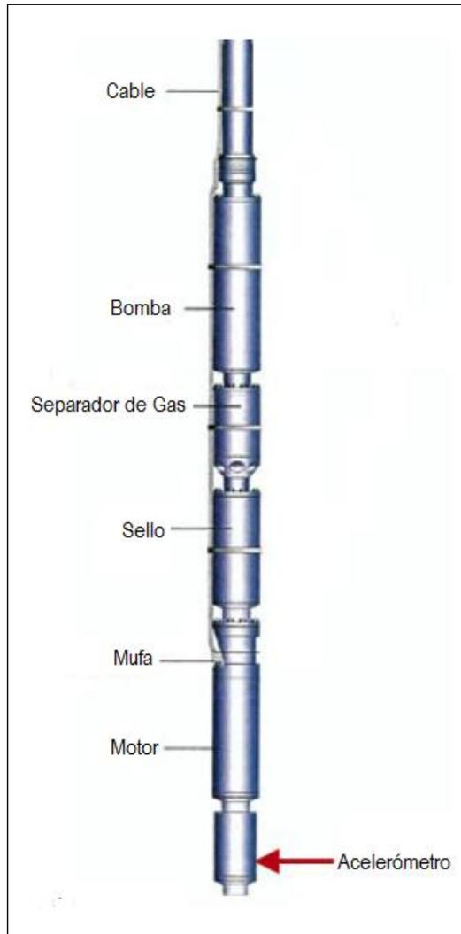
Figura 4.14 – Esquema de la Ubicación del Acelerómetro en el Sistema BEC (Baker Hughes Centrifugal, 2008)
