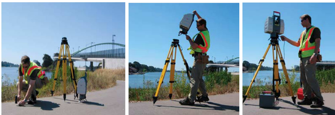
Fig. 16 Instalación en campo del escáner
