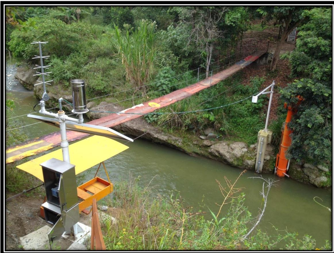
*Fig. 3.1.2 Estación Hidrométrica*
