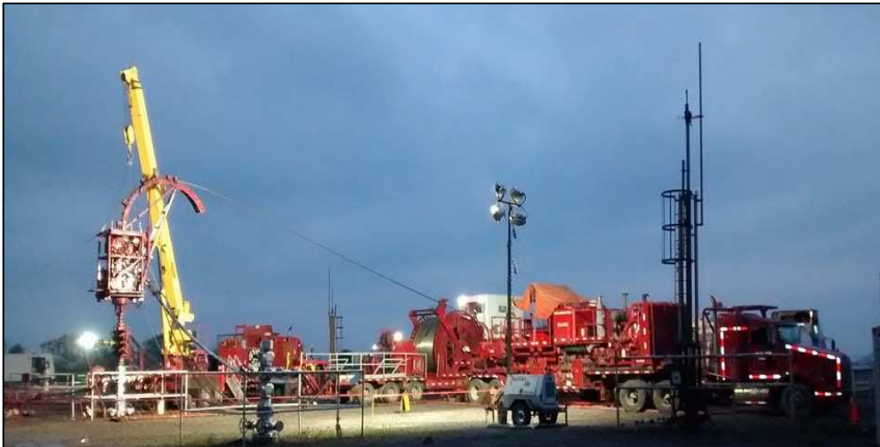
Figura 1.7 a Unidad moderna de Tubería Flexible 9
