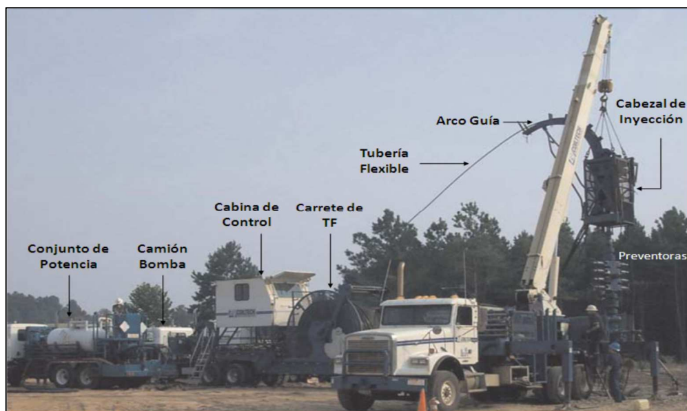
Figura 1.7 Unidad moderna de Tubería Flexible 8
