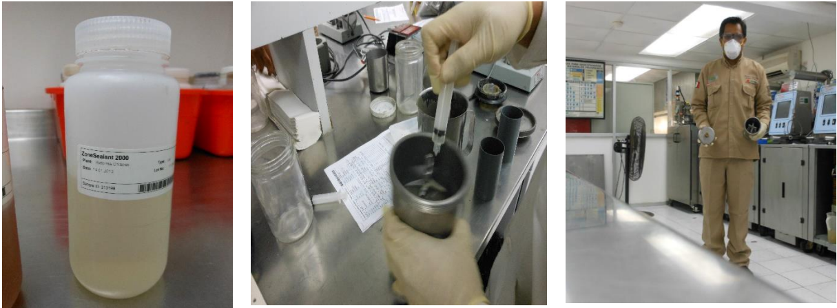
FIGURA 142. DETERMINACIÓN DE LA MASA DE LA LECHADA Y DEL SURFACTANTE O TENSIOLACTIVO
