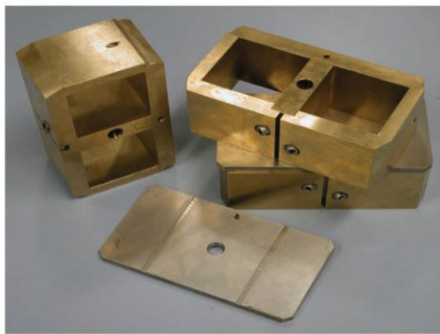
FIGURA 175. MOLDES DE FRAGUADO Y CAMARA DE BAÑO MARIA PARA LA COMPROBACIÓN DE RESISTENCIA COMPRESIVA EN UNA LECHADA DE CEMENTO ESPUMADO.
