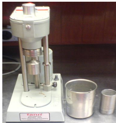
FIGURA 100. VISCOSÍMETRO RORTACIONAL FANN 35-a
