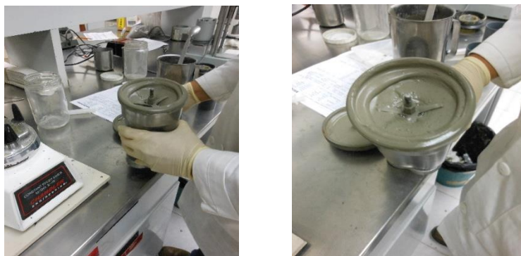
FIGURA 154. GENERACIÓN DE LA ESPUMA EN LA LECHADA DE CEMENTO
