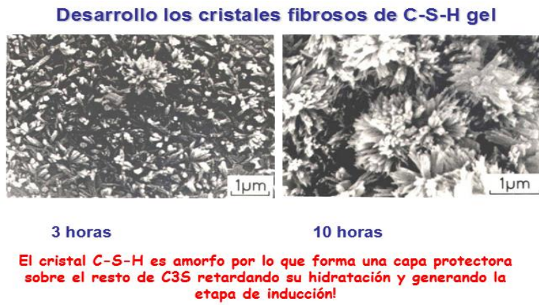
FIGURA 39. ETAPA INICIAL DE HIDRATACIÓN
