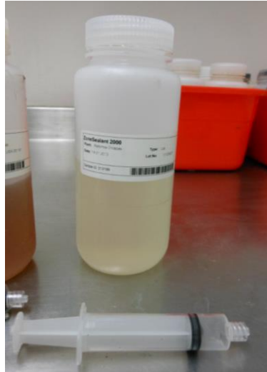
FIGURA 138. ADITIVO ZONE SEALANT 2000, AGENTE TENSOACTIVO SURFACTANTE O ESPUMANTE
