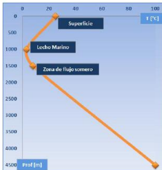
FIGURA 10. GRÁFICA DEL EFECTO DE TEMPERATURA SOBRE UNA LECHADA EN AP
