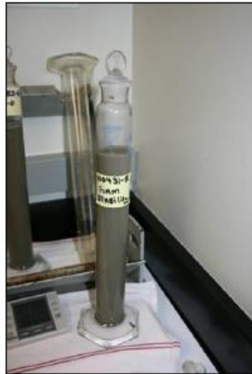
FIGURA 174. MUESTRA DE INESTABILIDAD EN UNA LECHADA ESPUMADA
