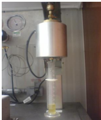
FIGURA 104. PROBETA CON FILTRADO DE UNA LECHADA DE CEMENTO
