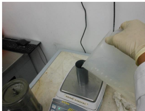
FIGURA 171. DETERMINACIÓN DE LA MASA DE CADA SECCIÓN
