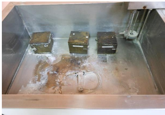
FIGURA 176. MOLDES PARA LA PRUEBA DE RESISTENCIA AL ESFUERZO COMPRESIVO EN UNA LECHADA ESPUMADA.
