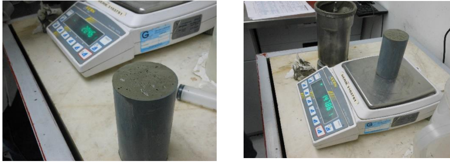
FIGURA 158. DETERMINACIÓN DE LA DENSIDAD DE LA LECHADA ESPUMADA.
