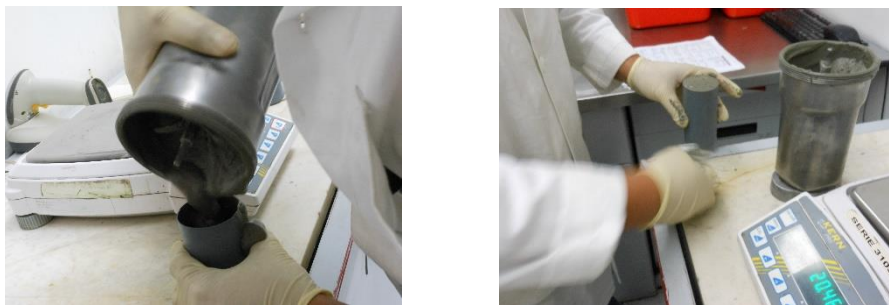
FIGURA 157. VACEADO DE LA LECHADA ESPUMADA EN EL RECIPIENTE DE DENSIDAD
