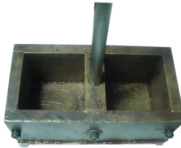
FIGURA 115. MOLDES CÚBICOS PARA PRUEBA DE RESISTENCIA COMPRESIVA
