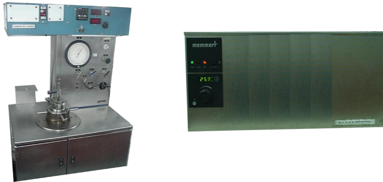
FIGURA 162. MONTAJE DE LA CELDA BP EN LA CAMARA DE CURADO A LA TEMPERATURA Y PRESIÓN DE PRUEBA
