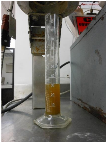
FIGURAS 183. CONSISTÓMETRO ATMOSFÉRICO 165-AT, EQUIPO FILTRO PRENSA FANN, MUESTRA DE FILTRADO EN UNA PROBETA POR PRESIÓN EXCESIVA Y CRONOMETRO A 30MIN COMO LO INDICA LA NORMA API 10-B2 PARA REALIZAR ESTA PRUEBA.
