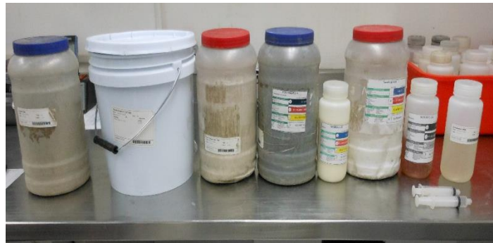
FIGURA 133. CANTIDADES DE MATERIALES ADITIVOS NECESARIOS PARA UN DISEÑO DE LECHADA
