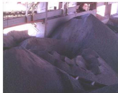
La materia prima en polvo se almacena por separado antes de iniciar el proceso de mezcla dosificada !
