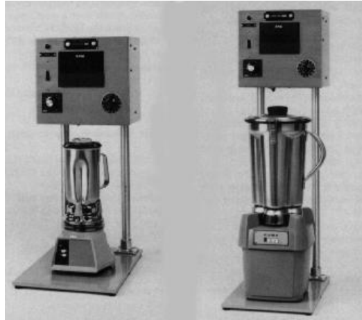
FIGURA 92. MEZCLADORA INDUSTRIAL CHANDLER 2 VELOCIDADES
