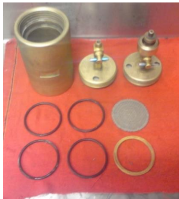
FIGURA 101. AUTOCLAVE DE ACERO, O-RINGS, ANILLO DE SEGURIDAD Y UNA MALLA DE 325 MESH SOPORTADA POR OTRA MALLA DE 60 MESH
