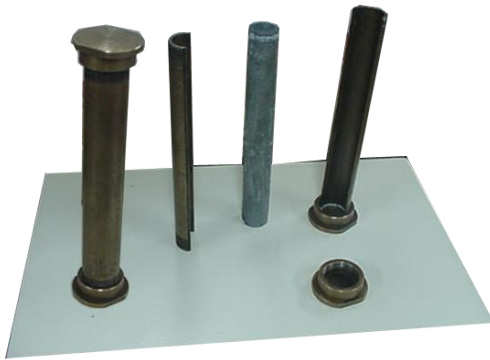
FIGURA 172. DESMONTAJE DE LOS MOLDES DE LA DETERMINACIÓN DE ESTABILIDAD DE UNA LECHADA ESPUMADA
