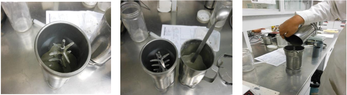
FIGURA 151. PREPARACIÓN DE LA LECHADA DE CEMENTO ESPUMADO A CONDICIONES ATMOSFÉRICAS
