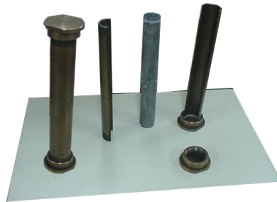
FIGURA 163. MOLDES DE FRAGÜE PARA LA DETERMINACIÓN DE LA ESTABILIDAD DE UNA LECHADA ESPUMADA
