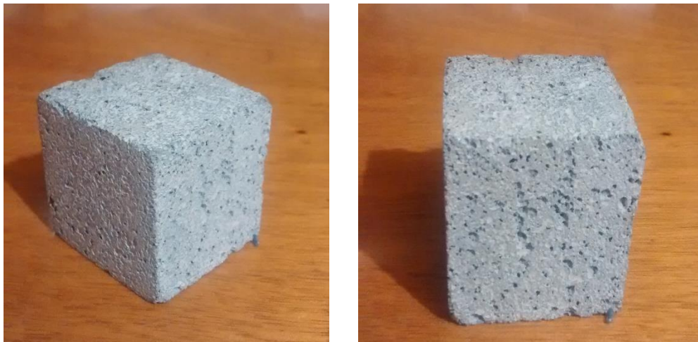
FIGURA 180. CUBOS FRAGUADOS DE LECHADAS ESPUMADAS A DENSIDADES MENORES QUE EL AGUA PERO CON ALTA RESISTENCIA COMPRESIVA.
