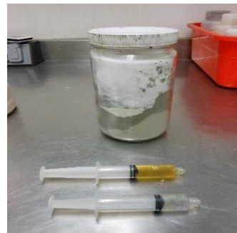
FIGURA 134. PESADO DEL CEMENTO Y DE LOS AGENTES ESPUMANTES
