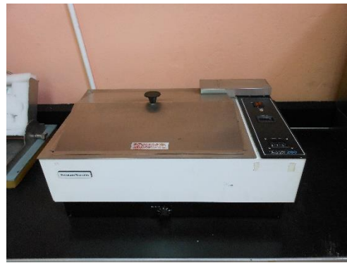
FIGURA 175. MOLDES DE FRAGUADO Y CAMARA DE BAÑO MARIA PARA LA COMPROBACIÓN DE RESISTENCIA COMPRESIVA EN UNA LECHADA DE CEMENTO ESPUMADO.
