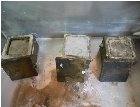
FIGURA 176. MOLDES PARA LA PRUEBA DE RESISTENCIA AL ESFUERZO COMPRESIVO EN UNA LECHADA ESPUMADA.
