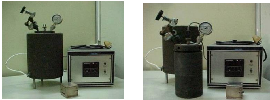
FIGURA 119. CÁMARA DE CURADO CON AUTOCLAVE, SISTEMA DE TEMPERATURA, Y MOLDES PARA FRAGUADO DE CEMENTO
