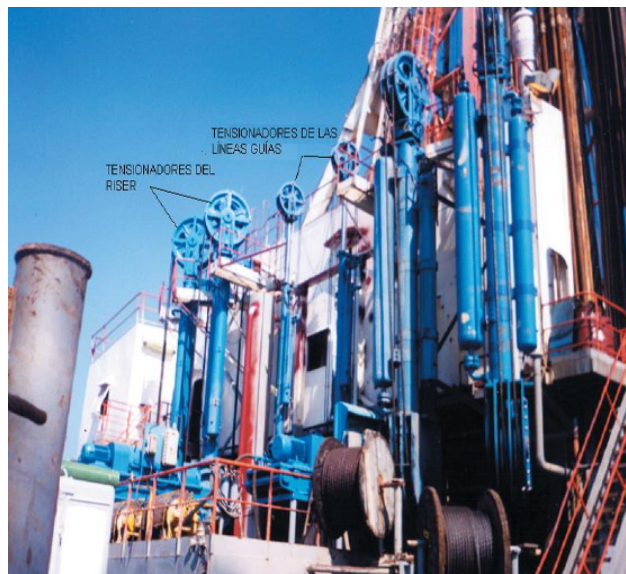
FIGURA 14. TENSIONADORES DE LÍNEAS GUÍAS.
