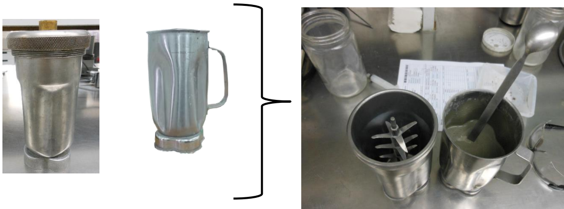
FIGURA 147. DETERMINACIÓN DEL VOLUMEN DEL RECIPIENTE DE MEZCLA PARA AMBOS VASOS DE MEZCLADOS (ESPUMADO Y CONVENCIONAL)
