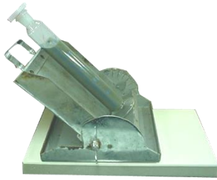
FIGURA 167. DETERMINACIÓN DEL EFECTO DE AGUA LIBRE PARA UN POZO DESVIADO A 45°
