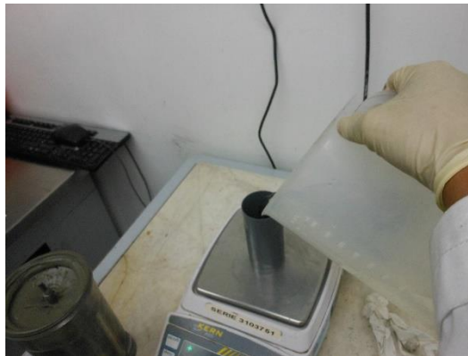
FIGURA 149. OBTENCIÓN Y MEDICIÓN DE LA TEMPERATURA DEL AGUA DE MEZCLA
