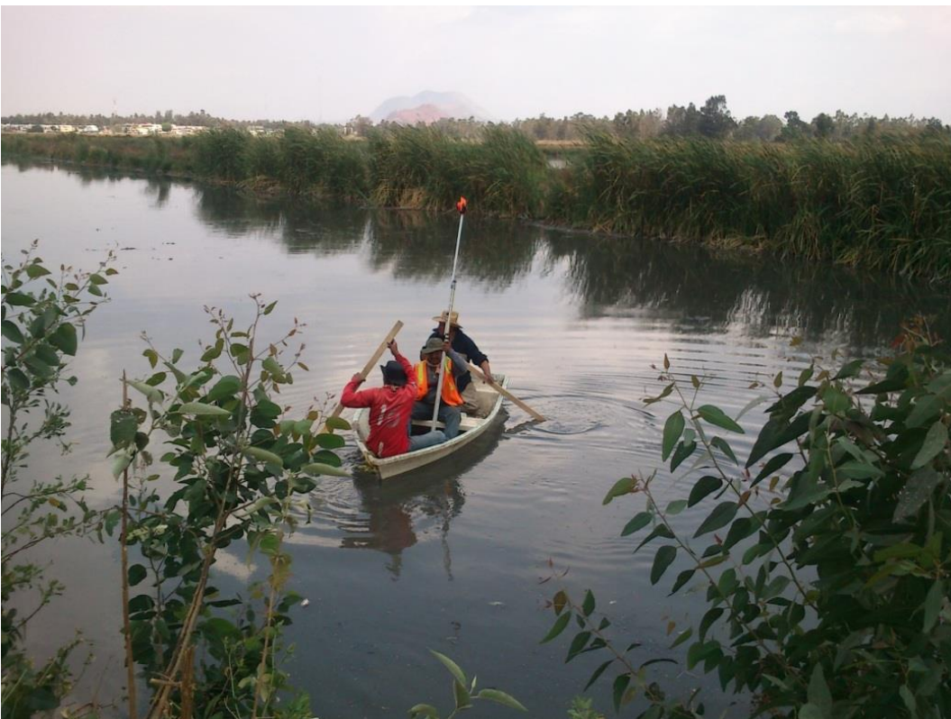
Imagen 3. Posicionamiento del prisma dentro del vaso regulador.
