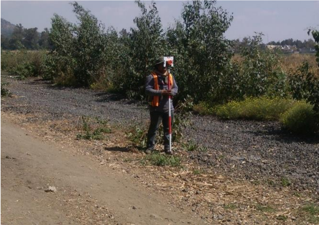
Imagen 2. Posicionamiento del prisma sobre bordo.
