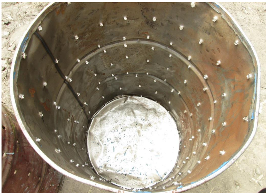
Imagen 43. Vista interior de contenedor con perforaciones.
