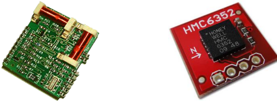
Figura 2.8 Compás magneto-inductivo (izquierda), y compás magneto-resistivo que lo reemplaza [12].
