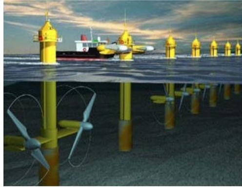
**Figura II.9. Arreglo modular de una central eléctrica de corrientes marinas.**
