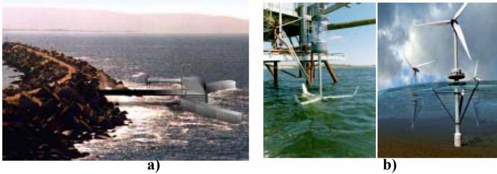
**Figura I.15 Dispositivos Near-Shore devices para aprovechamiento de oleaje. a) Energetch OWC b) Wave Rotor**
