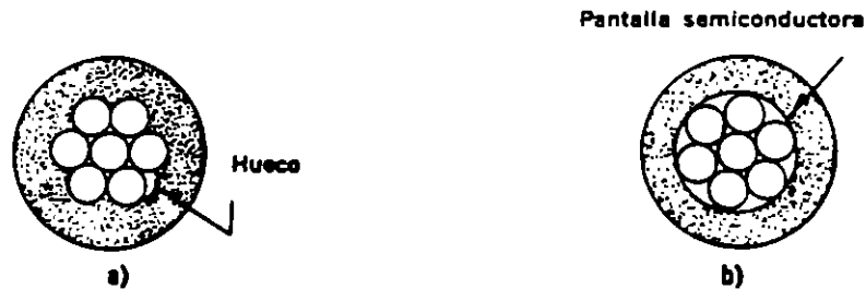
Fig. 3.2 a) Aislamiento directamente extruido sobre el conductor. b) Pantalla semiconductor.
