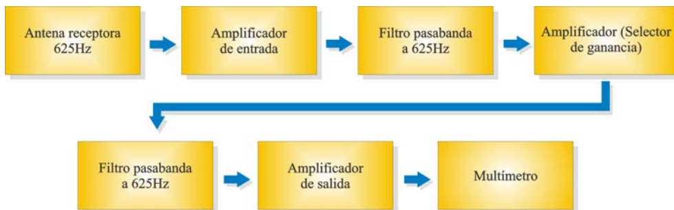
Figura 4.2. Diagrama a bloques del equipo receptor a 625Hz.
